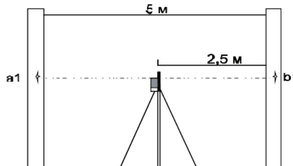
Установить лазерный уровень на расстоянии 0,5-0,7м от стены и нанести, как указано выше, те же отметки. Если разности  $\{a1-a2\}$  и  $\{b1-b2\}$  не отличаются друг от друга более чем на величину „точность”, заявленную в технических характеристиках, точность Вашего лазерного уровня в допустимых пределах.
