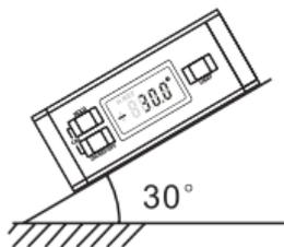
Нажмите коротко кнопку ON/REF/OFF, чтобы войти в режим Абсолютного измерения. На дисплее отобразится абсолютный угол.
